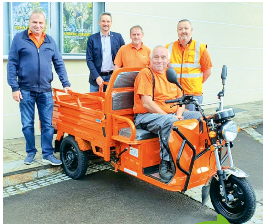
Das neue Elektro-Fahrzeug TUK TUK hat eine Reichweite bis 60 km, schafft 370 kg Nutzlast und wird in der Ortsbildpflege eingesetzt.
